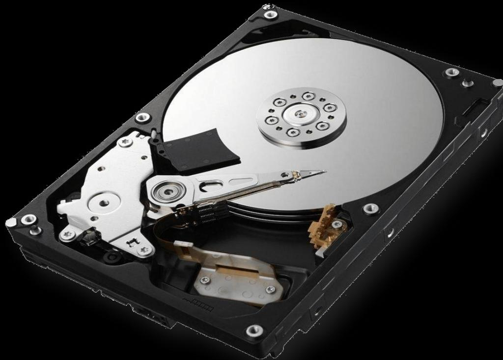
La unidad de disco duro o unidad de disco rígido, es el dispositivo de almacenamiento de datos que emplea un sistema de grabación magnética para almacenar archivos digitales. Se compone de uno o más platos o discos rígidos, unidos por un mismo eje que gira a gran velocidad dentro de una caja metálica sellada
